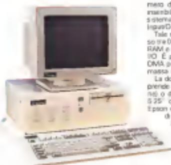
**S**iccome una macchina che si sta rapidamente diffondendo anche in Disitaco offre un modello che, come il nome Starter indica chiaramente, rappresenta l'entry point della gamma di sistemi MS-DOS basati sul processore Intel 80286 in questo caso ad una frequenza di clock massima di 15 MHz.
